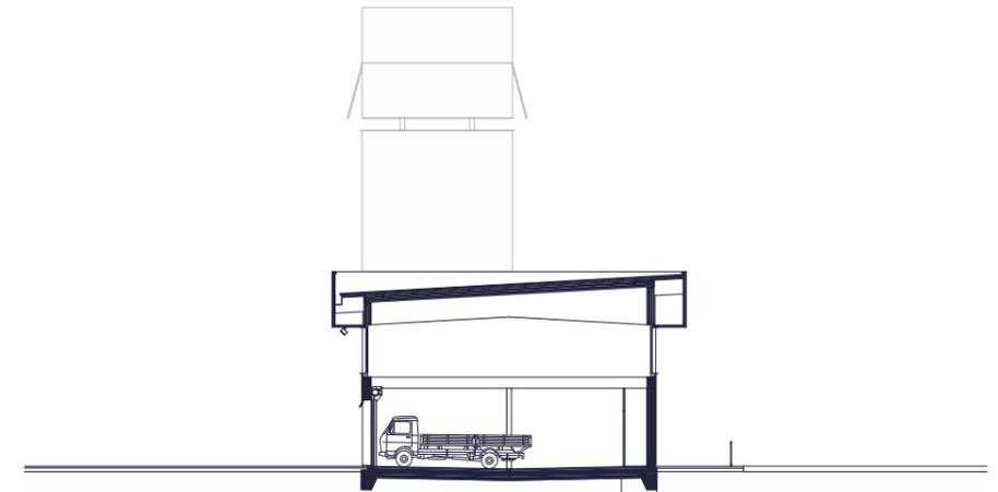
Querschnitt C-C - Bereich Einstellhalle
